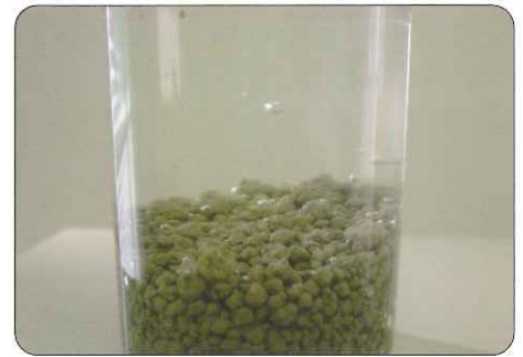
水中不溶化確認状況
